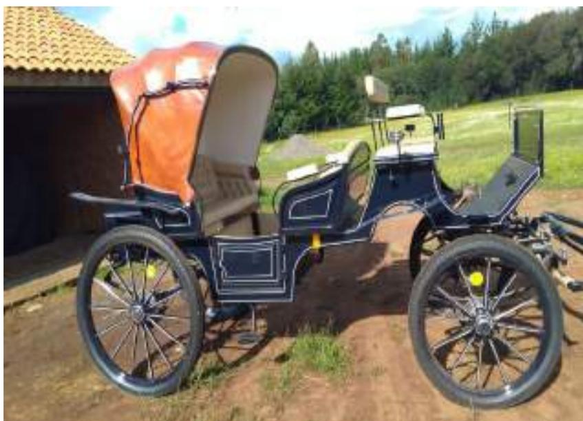
Frenos de disco delantero y trasero con pedal, freno de mano, suspensiones eliptical, Doble asiento principal en vis a vis con capota de cuero abatible. Asiento conductor delantero + acompañante.
